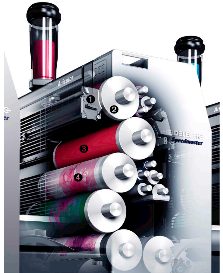
Von der über ein Kammerakelssystem ① mit Farbe gespeisten Rasterwalze ② gelangt die Druckfarbe genau dosiert auf die Farbauftragwalze ③ und von dort auf die Druckplatte ④. Im Vergleich zum konventionellen Offsetdruck ein sehr kurzer Weg!
