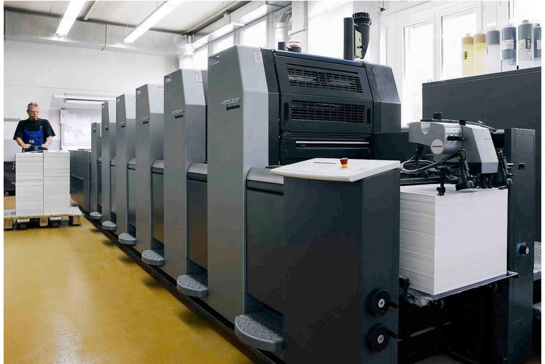
*Das neue Anicolor-Modell unterscheidet sich äusserlich nicht gross von einer konventionellen Speedmaster SM 52. Einzig die HandyFill-Farbversorgungsstationen rechts oben an den einzelnen Farbwerken stechen ins Auge. Trotz fünf Farbwerken, einem Lackwerk (hinten, etwas niedriger) und einem Trockenofen ist das System relativ kompakt.*
