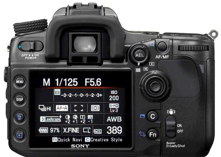
Die Rückseite der Alpha700 wird vom hochauflösenden 3-Zoll-LCD beherrscht, auf dem hier die Statusanzeige zu sehen ist. Sie ermöglicht auch einen schnellen Zugriff auf Einstellungen.
