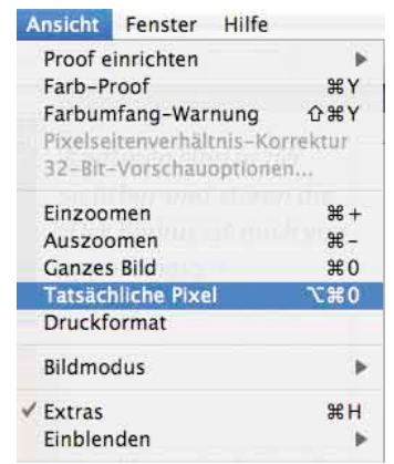
Der Ansichtsmodus «Tatsächliche Pixel» ist ideal für die Beurteilung der Schärfe, da für jedes Bildpixel ein Monitorpixel zur Verfügung steht.
