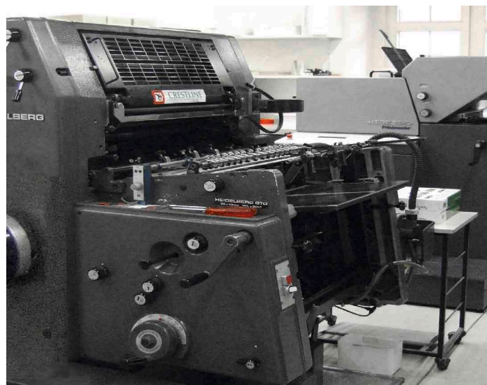
Die kleine Offsetmaschine wird nun neben dem Druck von grösseren Auflagen auch für das Priming der Papiere verwendet, die im Anschluss auf der HP Indigo press 3050 bedruckt werden. Dies erlaubt unter anderem ein eigenes Papiersortiment.
